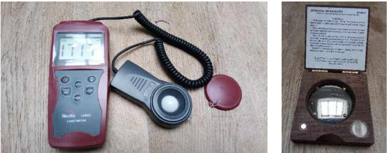
FIGUUR 7-1 Links een lichtmeter, vergelijkbaar met de lichtmeters die fotografen gebruiken. Je leest de gemeten hoeveelheid licht op één bepaald punt af in lux. Rechts een "sferische densiometer". Je moet het aantal hoekjes van de vierkantjes op de bolle spiegel tellen die niet door kronen bedekt worden, dit herhalen in elke windrichting en dan het gemiddelde met een bepaalde factor vermenigvuldigen. Vélér werk maar het geeft wel zeer goed het percentage van vol daglicht aan in het centrum van de kloemp. Foto's: Wim Buysse
