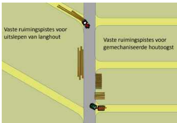
FIGUUR 3-4 Vaste ruimingspistes onder een hoek voor het optimaal uitslepen van langhout. Bron: Robbie Goris, Inverde
